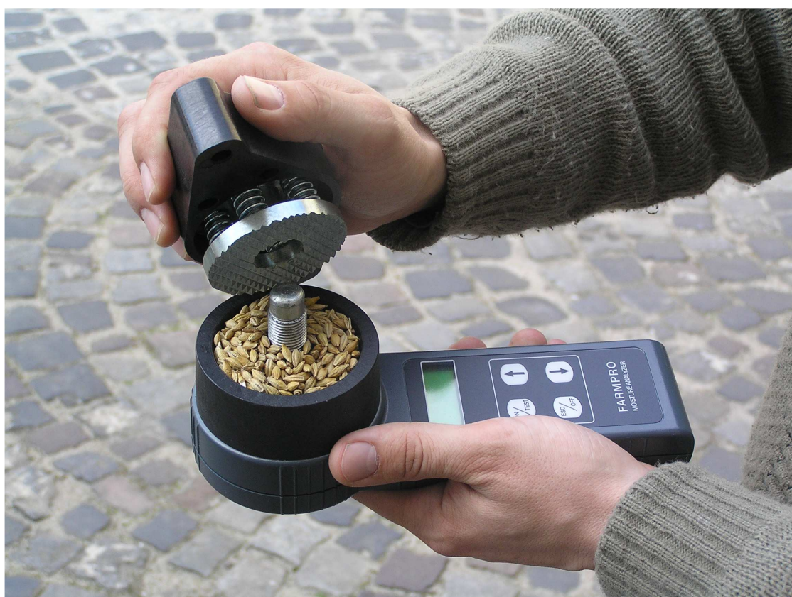
Foto 1. Pomiar wilgotności ziarna za pomocą miernika przenośnego (z funkcją wstępnego zmielenia)
